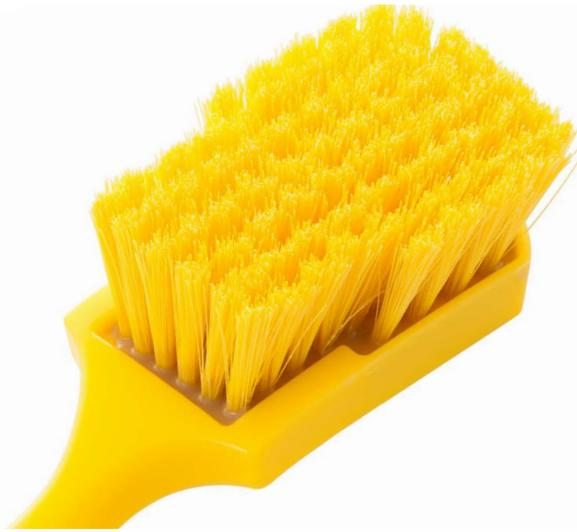
Nuestra gama Resin set consiste en una selección de productos con sus filamentos insertados en un compuesto de resina, mediante una técnica única sobre bloques fabricados a medida. Los filamentos se fijan al bloque mediante grapas de acero inoxidable y además se coloca la resina dentro y alrededor de cada bloque de fibras para una retención extrema.
