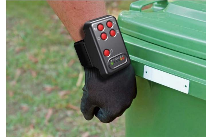
Las dimensiones compactas, la forma ergonómica y el peso reducido hacen que los lectores sean cómodos para el operador. Su robustez, caracterizada por una estructura a prueba de golpes y altos niveles de protección contra el agua y el polvo (IP 67), está diseñada para garantizar la máxima flexibilidad incluso en el uso más intenso sin el uso de envoltorios protectoras.
